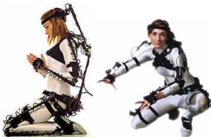
Figura 1.2 – Estrutura baseada em um Exoesqueleto
