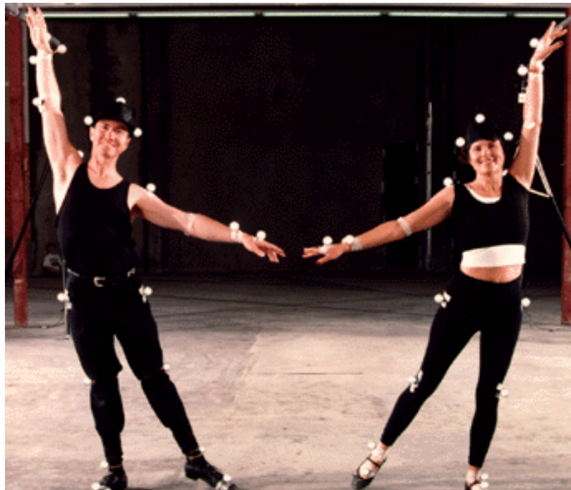
Figura 1.4 - Posicionamento dos marcadores
