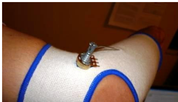
Figura 3.28 - Detalhe do movimento do potenciômetro
